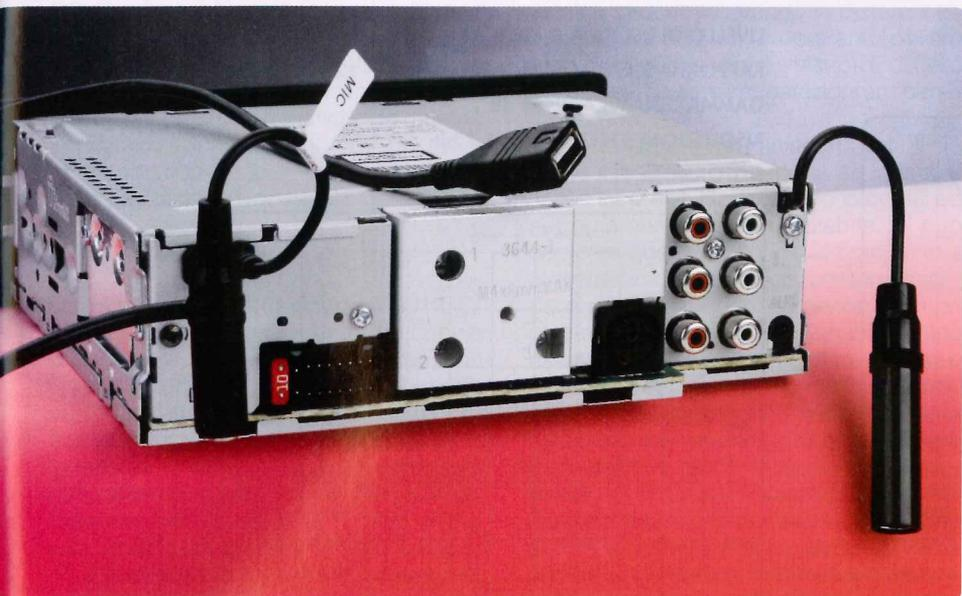
Il retro della sorgente Kenwood è tradizionale. I connettori di uscita del segnale audio sono sul fondo, nell'angolo in basso a destra, inusualmente veicolato da un connettore "jack", un ingresso ausiliario. A sinistra la connessione USB ed il piccolo jack per il microfono. Più al centro il multipolare per le connessioni di alimentazione e uscite amplificate (su connettori ISO sul solito cavetto in dotazione) ed il connettore per l'espansione verso il bus Kenwood.
